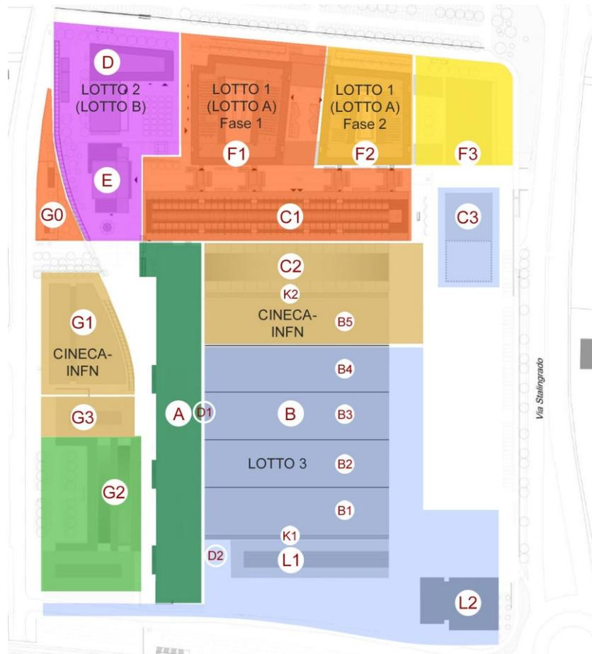
Il Data Center CINECA-INFN sarà collocato in 3 edifici esistenti (B5, C2 e G3) e in un edificio di nuova costruzione denominato G1 e destinato agli impianti, collegato a C2 da 4 tunnel interrati.
